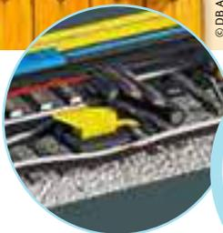
Greifer heben die alten Schwellen aus dem Gleisbett und setzen sie auf ein Förderband. Ein Förderkran transportiert sie an die Spitze des Zugs zur Ablage.
