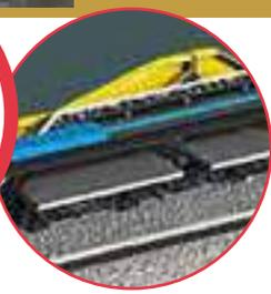
Aus dem Trichter fällt der Schotter links und rechts des Zugs zurück ins fertig umgebaute Gleis und wartet auf die Stopfmaschine.
