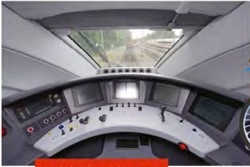
So sieht der Führerstand im ICE 4 aus. Hier stoßen sich auch große Lokführer beim Aufstehen nicht den Kopf. Und alle Instrumente sind auf einer Ebene ganz übersichtlich angebracht.
